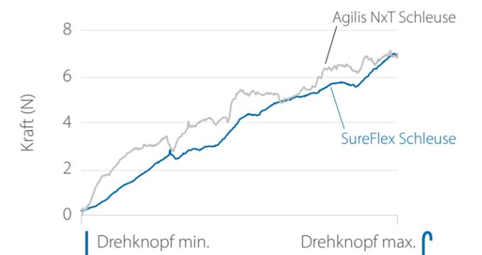
Abbildung 4 Kraft/Rotations-Profil repräsentativer Schleusen-Proben
