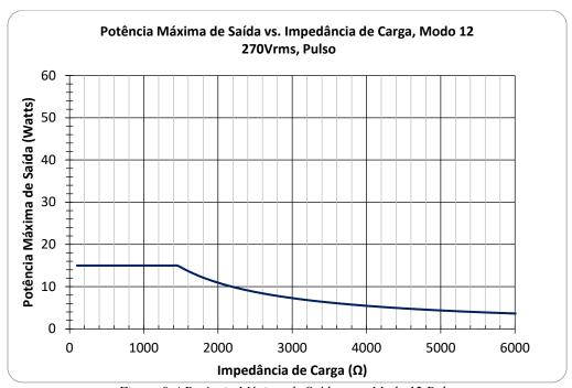
Figura 9-4 Potência Máxima de Saída para Modo 12 Pulso
