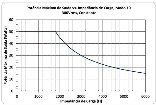
Figura 9-1 Potência Máxima de Saída para Modo 10 Constante
