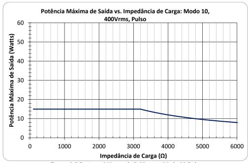
Figura 9-2 Potência Máxima de Saída para Modo 10 Pulso
