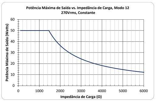
Figura 9-3 Potência Máxima de Saída para Modo 12 Constante
